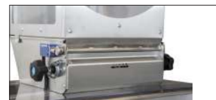
Загрузочные створки в бункере с индикатором размеров.
