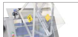
Защитный кожух откидной для легкой очистки.
