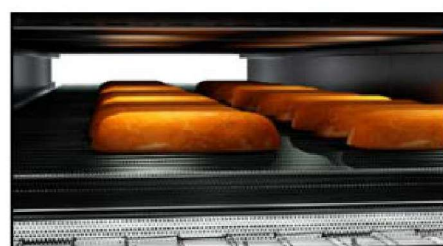
Перфорированная стальная лента используется для выпечки хлеба произвольной формы, высокого хлеба и т.д.
